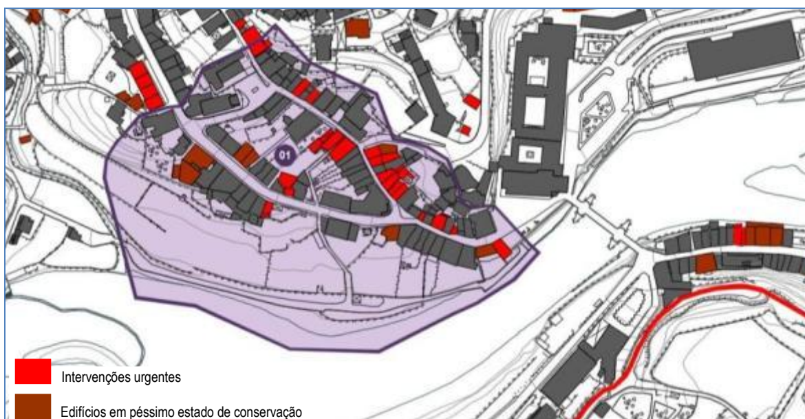
Fig. 13 - Edifícios em péssimo estado de conservação com identificação de intervenções urgentes
